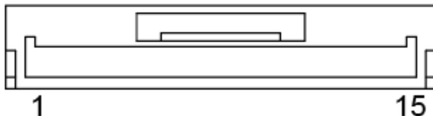
图 4-5 I/O2 连接器 PIN 顺序
